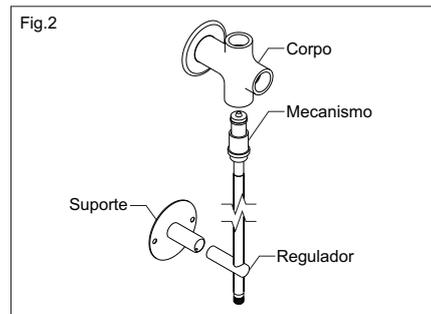
5. Retire o **mecanismo** do **corpo** do adaptador e fixe o **suporte** na parede conforme Fig.3.
