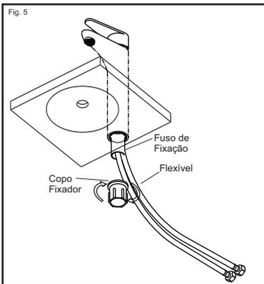
6. Coloque os nipes no flexível e conecte nas entradas de água.
